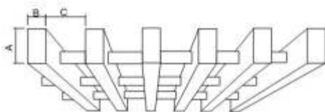
Listones de madera maciza unidos transversalmente con tubo metálico negro
