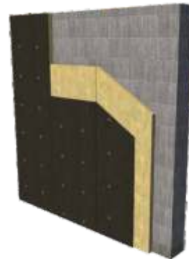
Sistema forrado para muros de mampostería.
