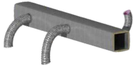
Inyección de aire acondicionado.
